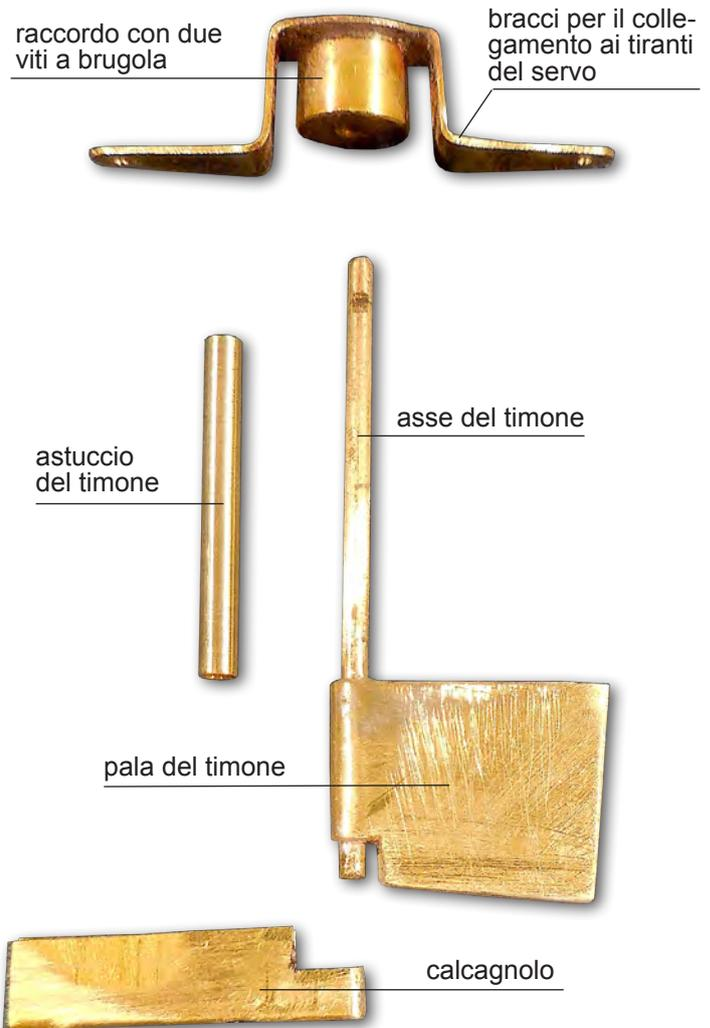
L'astuccio, ovvero il tubetto all'interno del quale si infila l'asse del timone, deve alzarsi oltre la linea di galleggiamento quanto basta per evitare che l'acqua trabocchi all'interno dello scafo.
