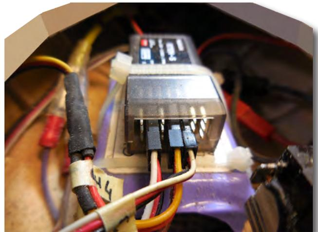
L'immagine qui sopra mostra il ricevitore. E' la parte del sistema di radiocomando (RX) che viene installata bordo e riceve i segnali che provengono dal trasmettitore (TX) che sta nelle mani del modellista.
